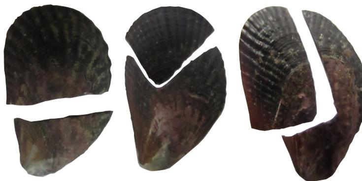
**Figura 4.4.** Valvas menores al tamaño 5 después de ser sometidas al ensayo de flexo-compresión
