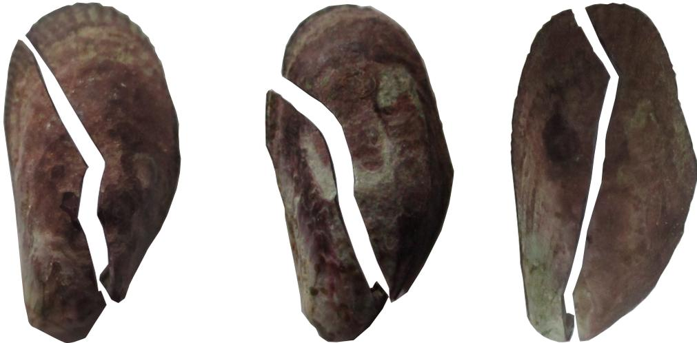
**Figura 4.5.** Valvas del tamaño 5 después de ser sometidas al ensayo de flexo-compresión
