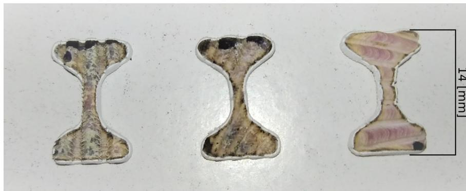
**Figura 2.13.** Probetas a 90°, 45°, y 0°, respectivamente, cortadas en cortadora láser a bajas potencias. Imagen extraída de [99]
