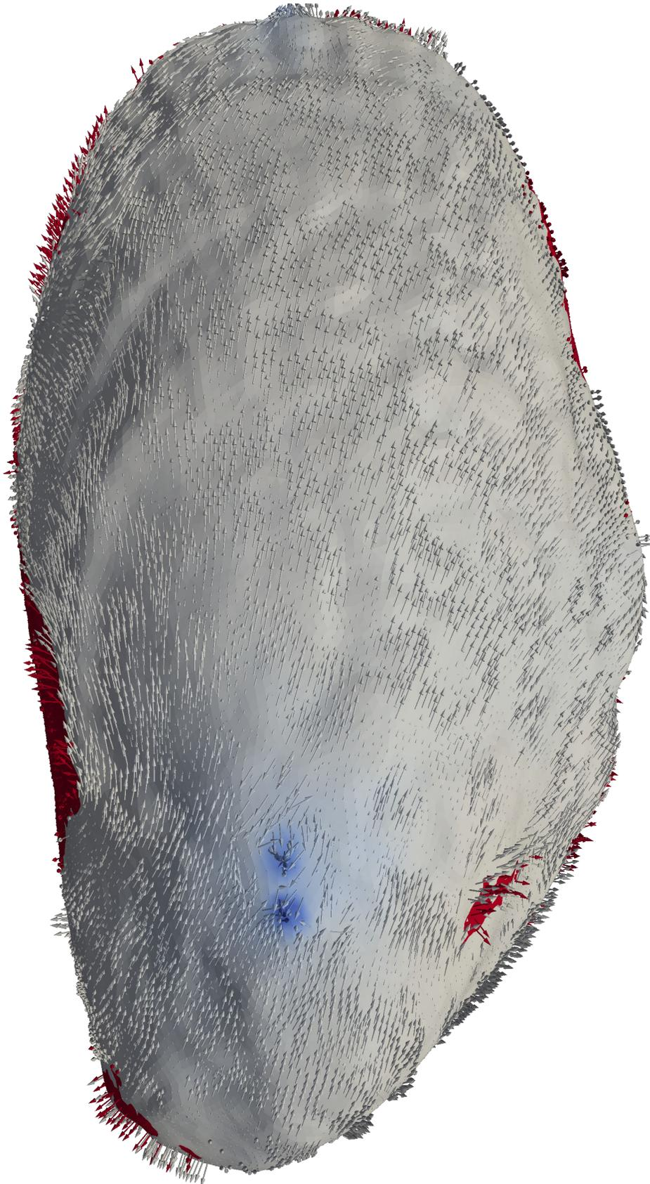
Figura 5.78. Dirección del esfuerzo principal 3 ( $\sigma_3$ ). Software *ParaView*. Tamaño 5
